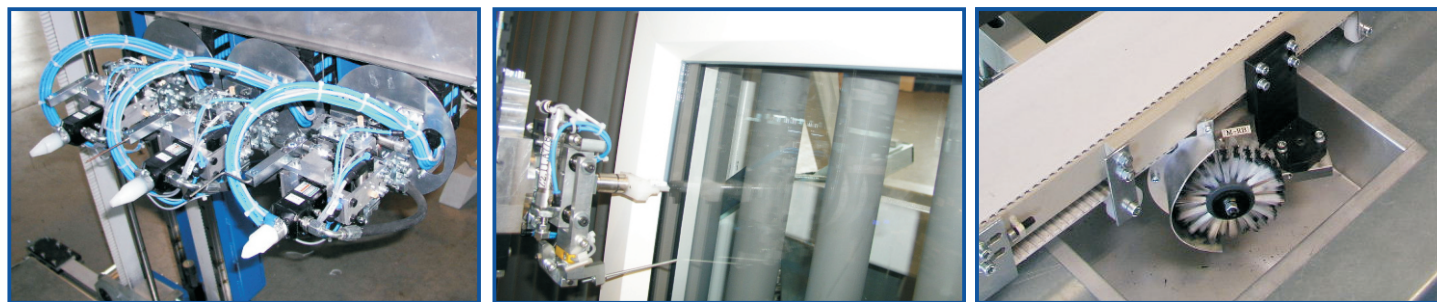
Eine automatische Bürsteneinrichtung zum Reinigen der Düsen nach jedem Versiegeln ist standardmäßig integriert.
