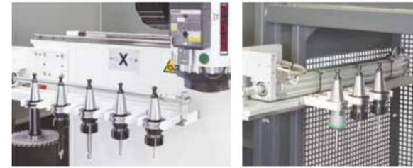
**2** Magazzino utensili a 5 posizioni a bordo macchina, può contenere utensili per forare, fresare, maschiare, intestare. Un secondo magazzino può essere aggiunto sul lato destro (opzionale)
