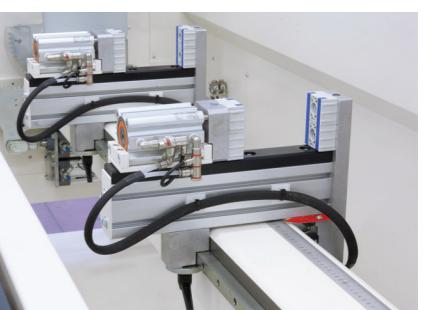
Le morsie di bloccaggio scorrono su guide lineari di precisione con pattini a ricircolo di sfere, con posizionamento manuale supportato da un indicatore laser gestito da CN
